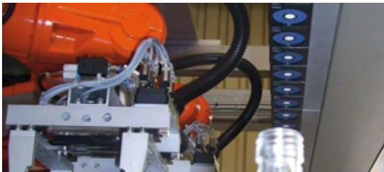
Cellule de capteurs synchronisée dans la production de bouteilles en verre
